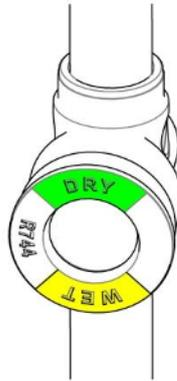
Die Anzeige auf der Flüssigkeitsleitung des Verflüssigungssatzes, gekennzeichnet als ND1 für den Flüssigkeitsdurchgang, **muss** grün leuchten, um das Fehlen von Feuchtigkeit anzuzeigen.
