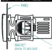
Die Tafelbau-Geräte XR60C sind für einen Ausschnitt 71x29 mm vorgesehen und werden mit zwei Befestigungsbügel fixiert. Die Befestigungsbügel von hinten aufschieben und durchschieben bis beide Bügel fest einrasten.
